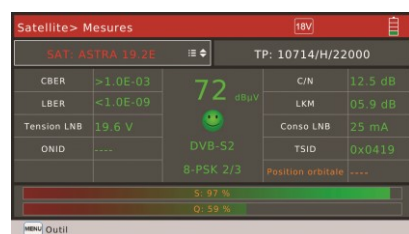
Menu de mesure (puissance et qualité) du signal Satellite
